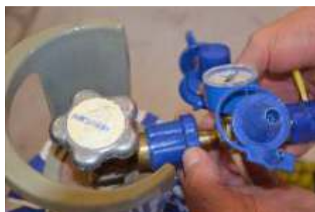
Ventil bis zum ersten größeren Widerstand aufschrauben. Kein Werkzeug verwenden!!!
