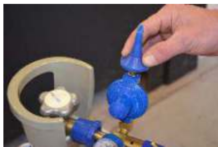
Ventil einmal drücken um das Restgas entweichen zu lassen!
